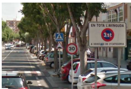
Imatge 5.113. Senyal de limitació de circulació de vehicles de més de 3,5 tones
